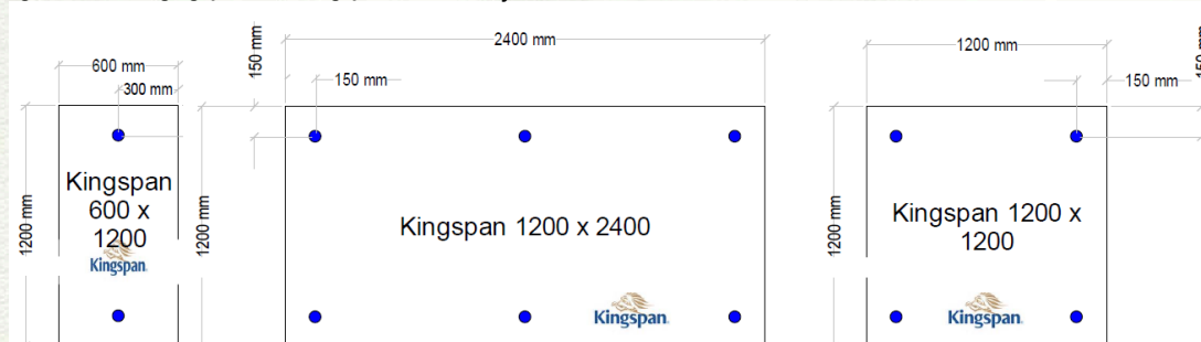
Figuur 4: Bevestigingspatronen Kingspan Therma™-systeem niPIR-N
